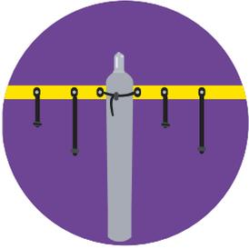
Los cilindros están anclados a la pared o jaula con sistema de cadenas o barra, en posición vertical.
