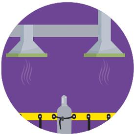
Los cilindros se almacenan en espacios bien ventilados, protegidos del sol, del agua, de la humedad y de ambientes corrosivos.
