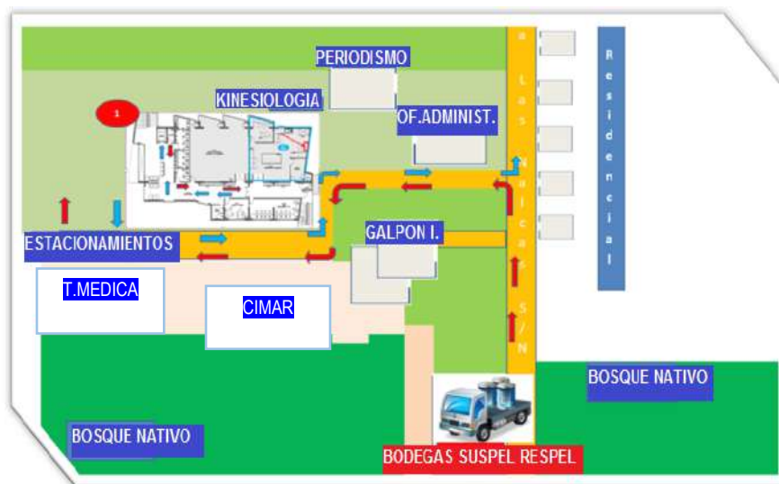
Fig. 1. Ruta interna de traslado residuos peligrosos, Escuela kinesiología y Escuela de Tec. Médica
