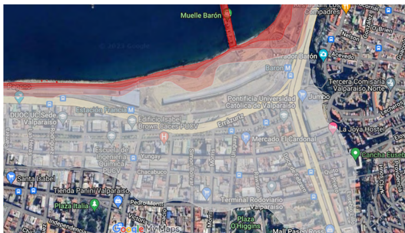
Figura 1: carta de inundación por tsunami de Valparaíso.
