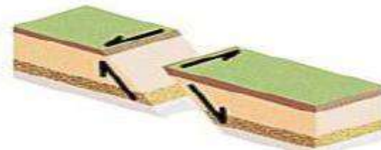
Falla oblicua con desgarre
